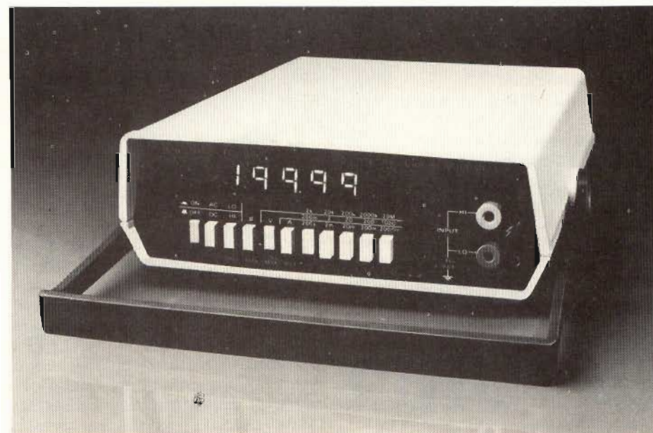
Fig. 1/b - Altro multimetro digitale a 4 cifre e mezzo della Keithley Mod. 179.
