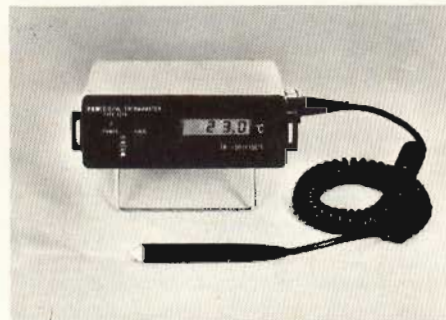
Termometro digitale per temperature da -50^{\circ}\text{C} a +150^{\circ}\text{C} .
