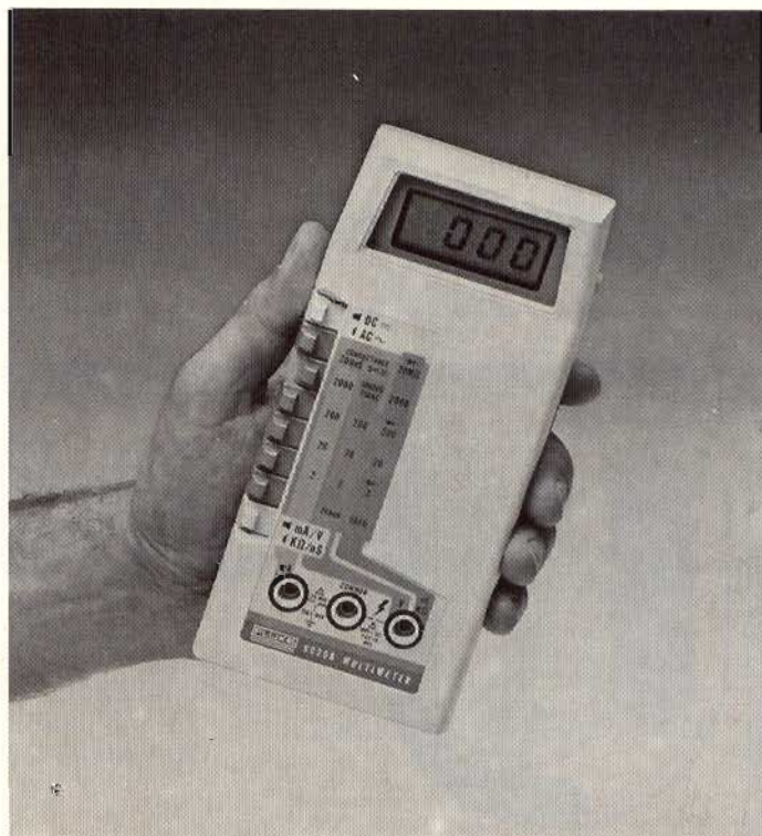
Fotografia del nuovo multimetro digitale Fluke Mod. 8020A: si notino la sobrietà della linea e la razionale disposizione dei commutatori di funzione e di portata.
